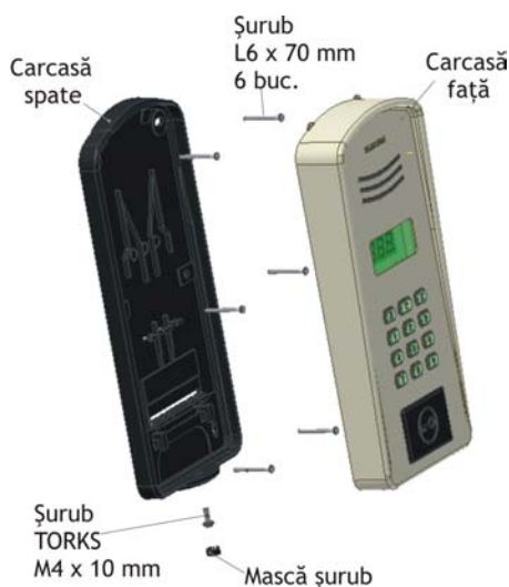
Fig. 2 Instalarea panoului exterior PES.A255
