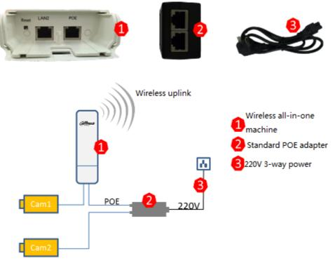
Figure 2-3 DH-PFM881 Installation Diagram
