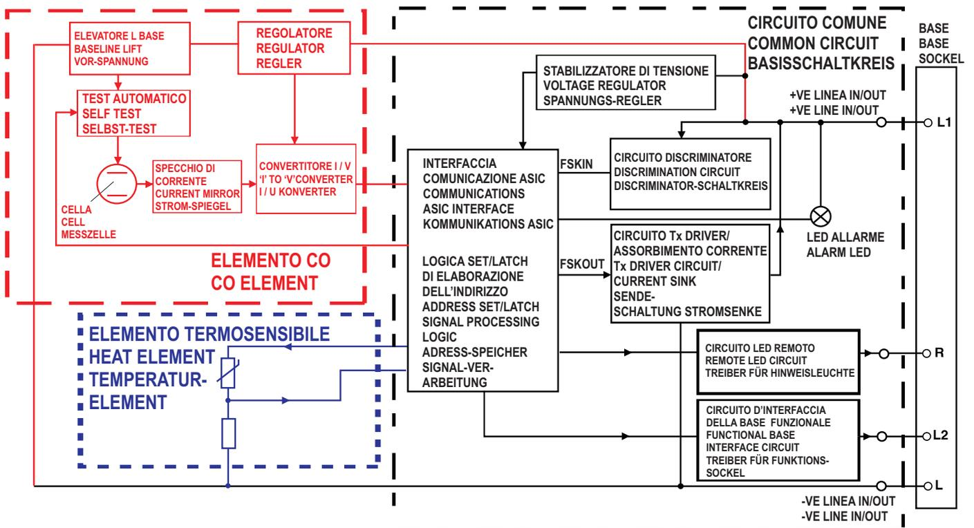
FIG.3 Schema a blocchi semplificato del rilevatore
