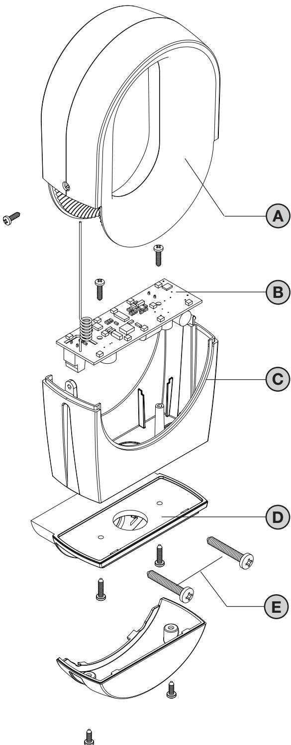
calotta lampeggiante - flashing cap
