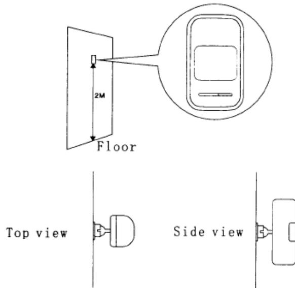
Dupa montarea detectorului in suport si fixarea acestuia pe perete, ajustati pozitia senzorului astfel incat directia de deplasare a persoanelor sa fie cuprinsa intr-un unghi de 110 grade. Detectorul este sensibil la miscarile pe verticala si mai putin sensibil la miscarile pe orizontala.
