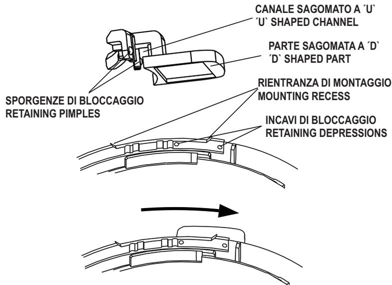
**FIG.6** Inserimento della linguetta indirizzo
